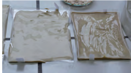
Abb. 1a Trocknung des Weintrubs in Wannen aus PE-Folie
