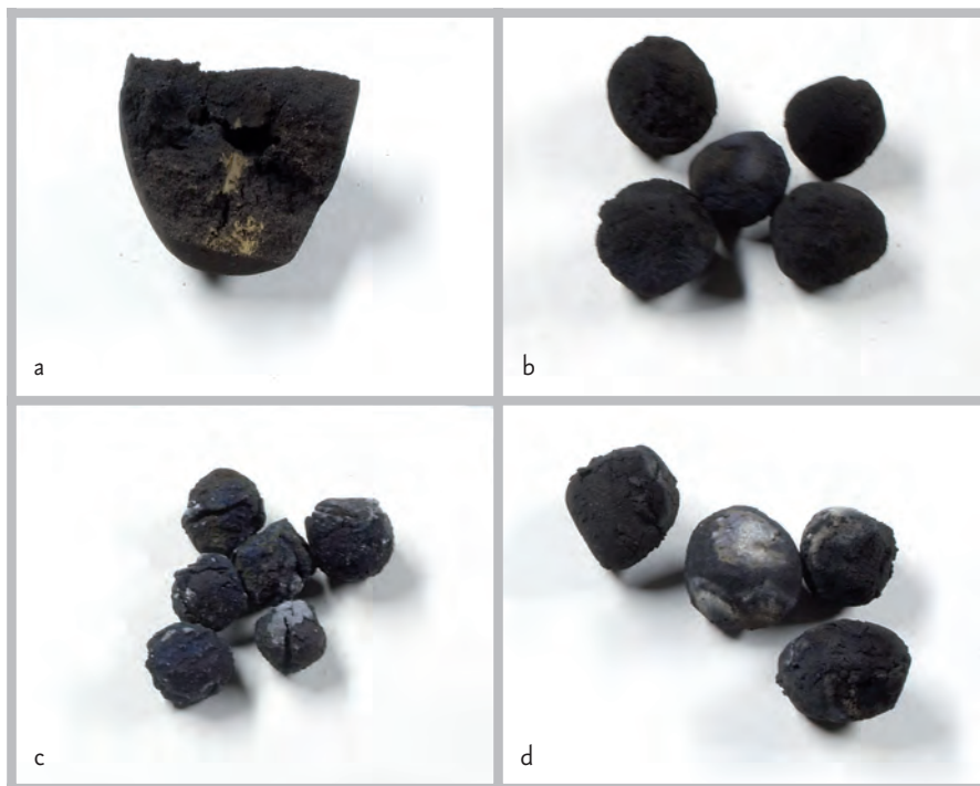
Abb. 4: a. Weintrub (Riesling), 120 min bei 310 °C, unvollständig verkohlt; b. Weintrub (Riesling), 300 min bei 380 °C; c. Weintrub (Burgunder), 300 min bei 380 °C; d. Weintrub, 300 min bei 380 °C, Deckel abgefallen, Aschebildung
