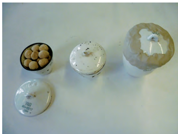
Abb. 3 Tiegel befüllt mit Kugeln, geschlossen, versiegelt (v. l. n. r.)
