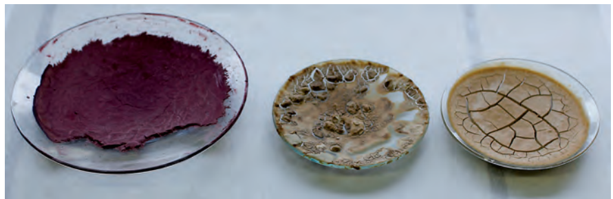
Abb. 1b Trocknung des Weintrubs (links Burgunder, rechts Riesling) in Wannen aus PE-Folie
